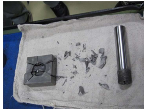
材料（左）を割り、引き分けに持ち込んだドリル
