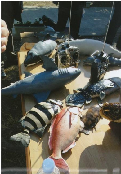
水中生物ロボット、ペットボトルやウェットスーツの切れ端、車などの廃材から林君が自作
